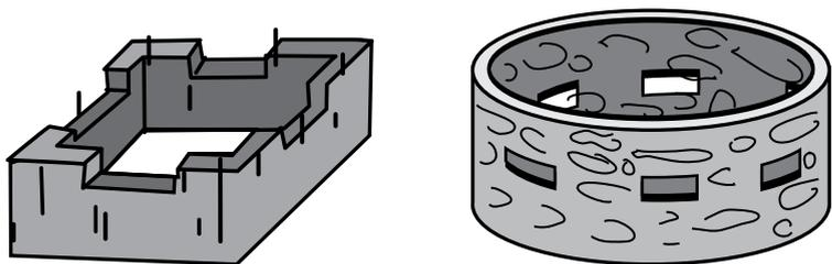
En el bando republicano existe un modelo particular, caso de la posición Loma de San Macario, en el que se utilizó el ladrillo como material constructivo, se empleó el semicírculo con corredor lateral como planta y se sustituyeron las amplias troneras por una serie de aspilleras.
